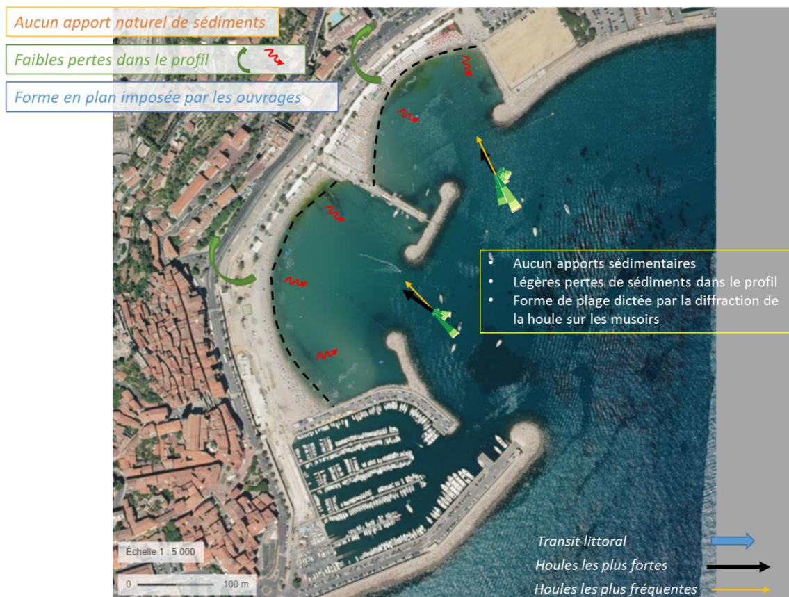
Figure 17 : Schéma de fonctionnement hydrosédimentaire des plages des Sablettes
